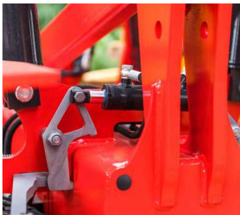
Carrier XT легко управляется из кабины трактора, включая гидравлический замок крыльев.
