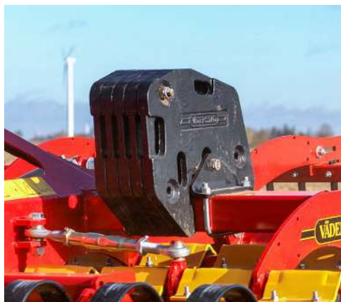
Carrier 300-400 может быть оборудован грузами, увеличивающими вес машины до 800 кг/м.
